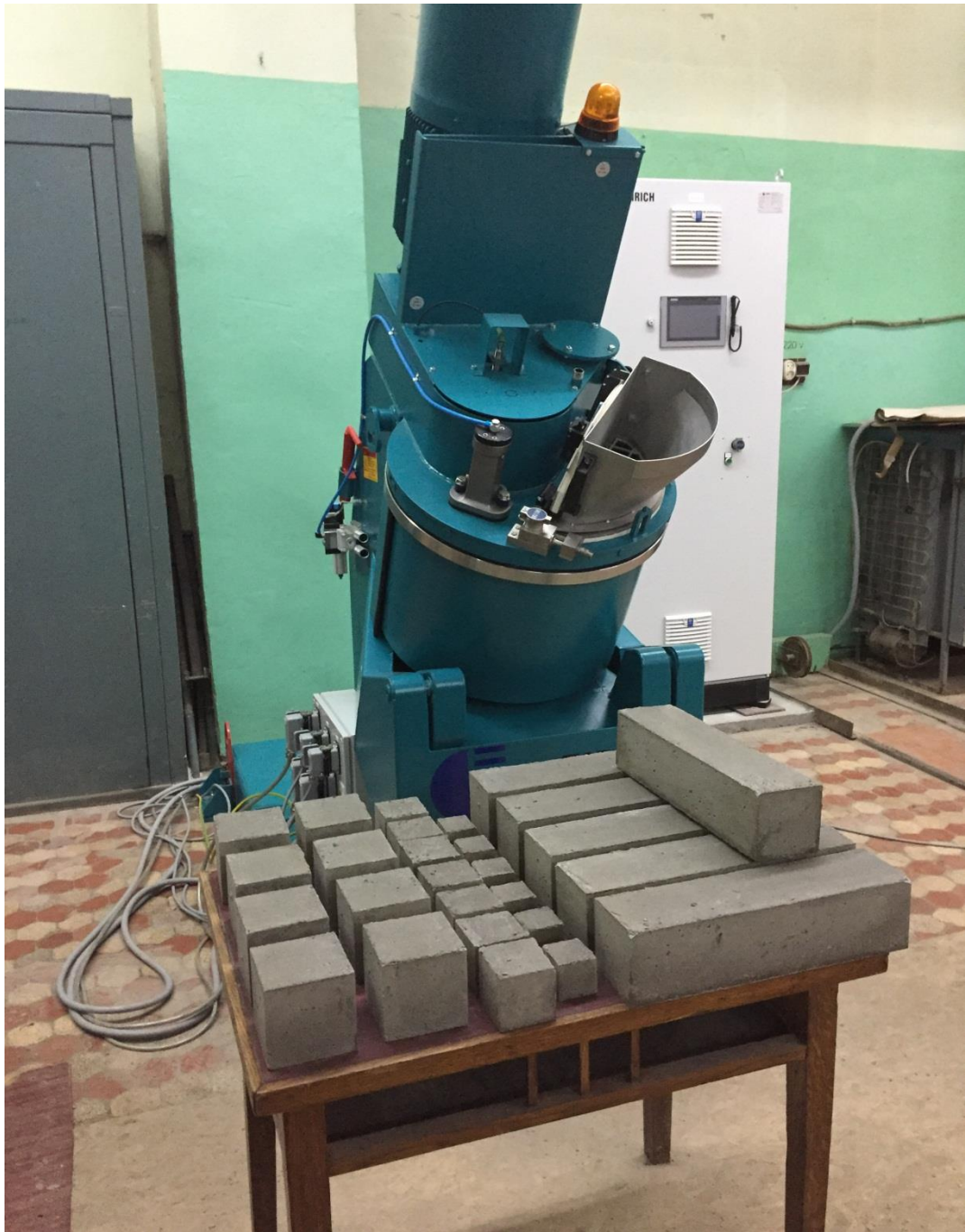
Рис. 14. Загальний вигляд бетонних зразків виготовлених на бетонозмішувачі «Айріх»
