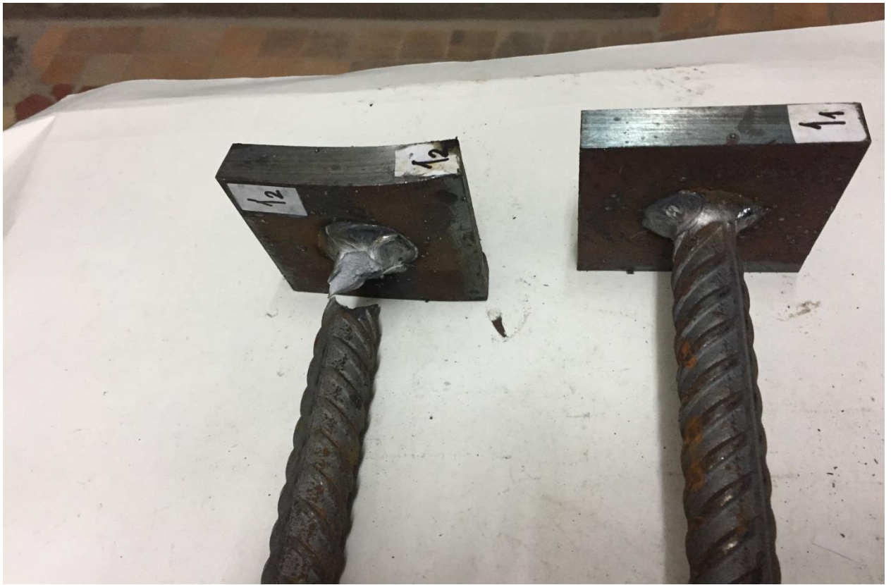
Рис. 11. Дослідження міцності стику арматурного стрижня з металевою пластиною
