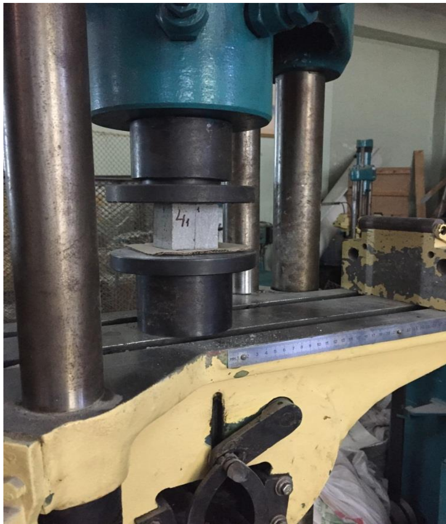
Рис.2. Випробування зразків-кубів на пресі УММ-20
