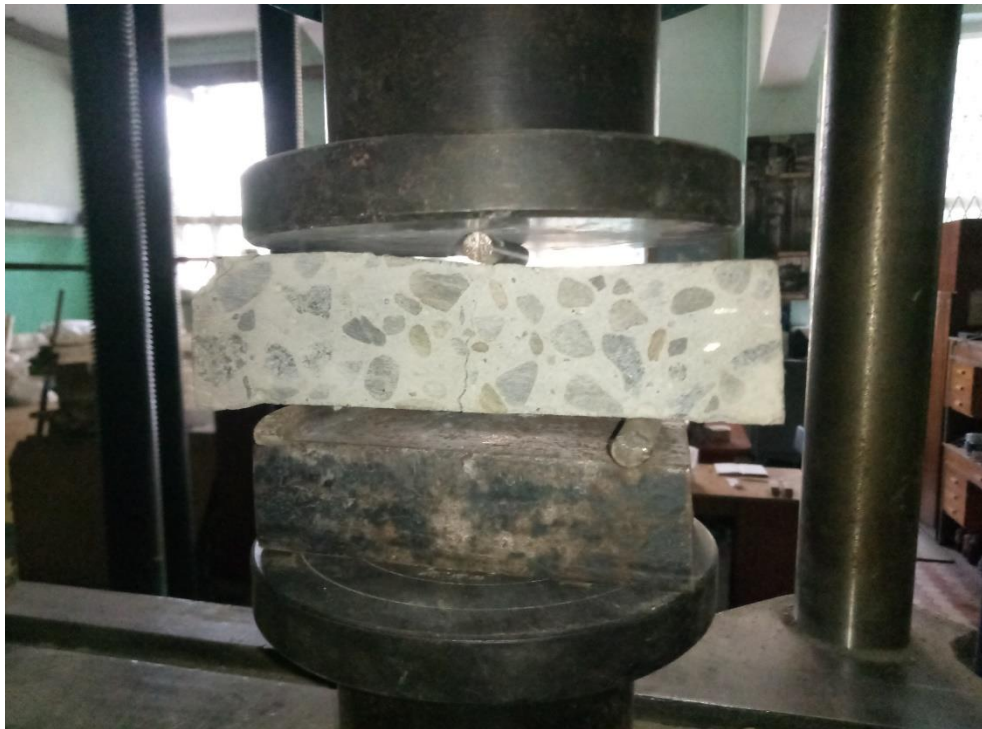
Рис.4. Випробування зразків-балок з фібробетону на пресі УММ-20
